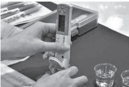
図2 導電率計での測定の様子
