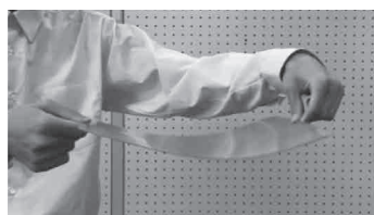
図2 下敷きから音を発生させる様子
