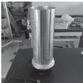
写真3 ステンレス板を側面に貼った電気鍋
