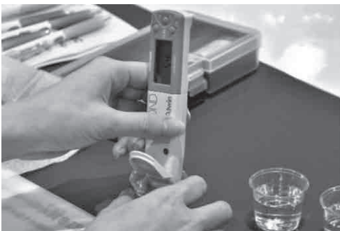
図2 導電率計での測定の様子
