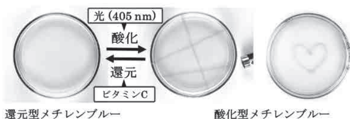
図1 青色レーザーを照射した際の変化の様子
