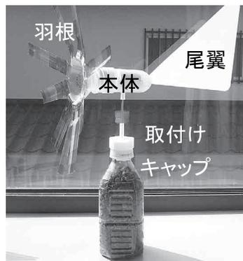
図1 ペットボトル・LED風車
