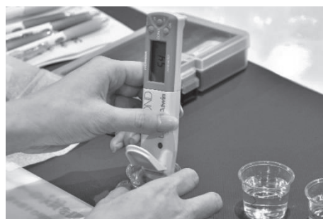
図2 導電率計での測定の様子
