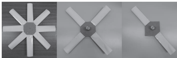
図2 羽根の枚数の違う風車のプロペラ
