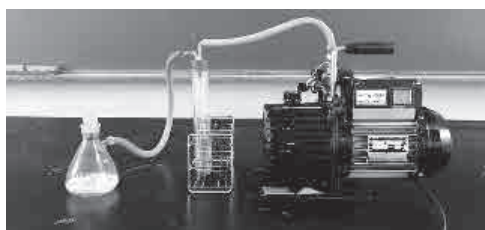
図1 真空状態にするための装置
