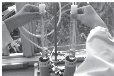
図1 インジゴ水溶液を用いたオゾン濃度測定実験の様子
