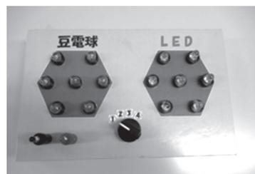
図1 LED・豆電球比較実験器
