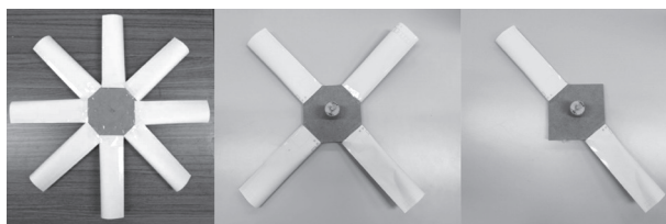
図2 羽根の枚数の違う風車のプロペラ
