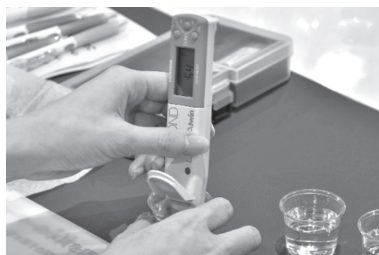
図2 導電率計での測定の様子
