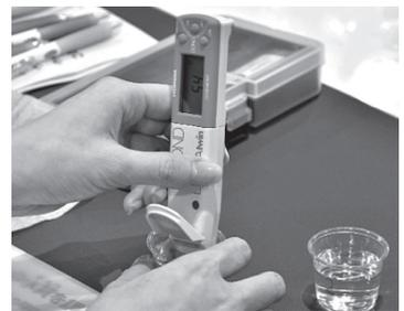
図2 導電率計での測定の様子
