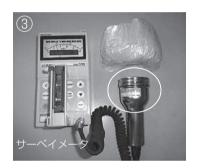
①、②、③は、アルファ線やベータ線が通過したときに物質から電子を引きはがす電離作用を、それぞれ異なる方法で測定します。 ④ではエックス線を出す放射性物質を放射線カメラで撮影します。実際に測定をしたり、放射線を観察したりして、アルファ線、ベータ線、エックス線、ガンマ線の飛距離の違いや透過力について考えてみましょう。また、どうして放射線がはかれるのか説明をきいて想像してみましょう。
