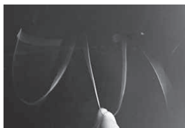
写真2 指の左右のピアノ線が交互に振動する
