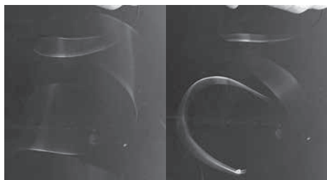
写真3 縦振動と横振動が交互にできる
