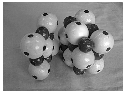
写真2 岩塩の へきかい 劈開モデル
